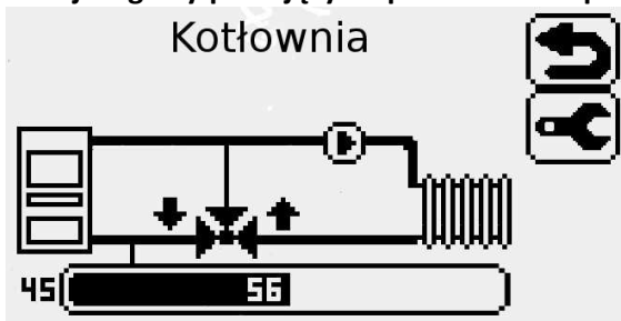
d) zawór czterodrogowy zasilający ogrzewanie podłogowe
