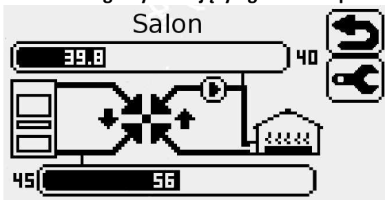
e) zawór czterodrogowy zasilający ogrzewanie grzejnikowe lub cały węzeł cieplny
