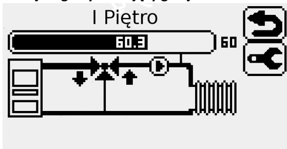
c) zawór trójdrogowy pracujący na podmieszaniu powrotu
