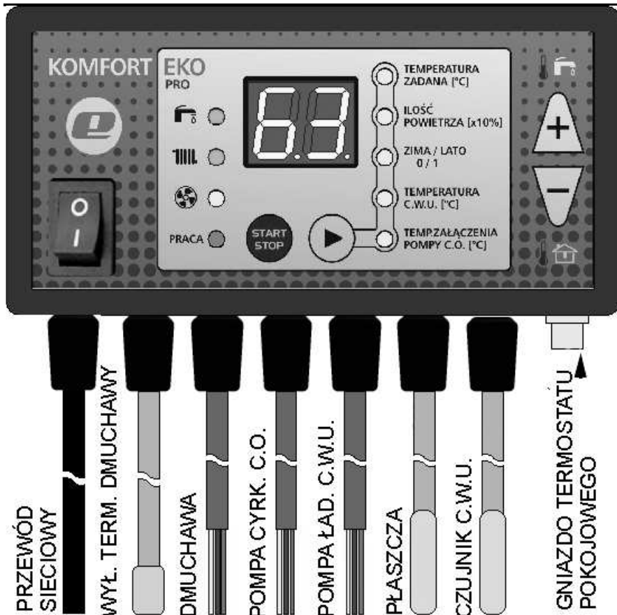
Rys.2. Wyprowadzenia przewodów i czujników z obudowy regulatora
